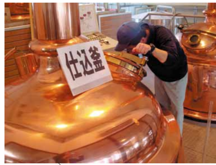
仕込検査 麦汁の糖度、PHを測定
