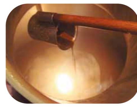
仕込検査 麦汁の糖度、PHを測定
